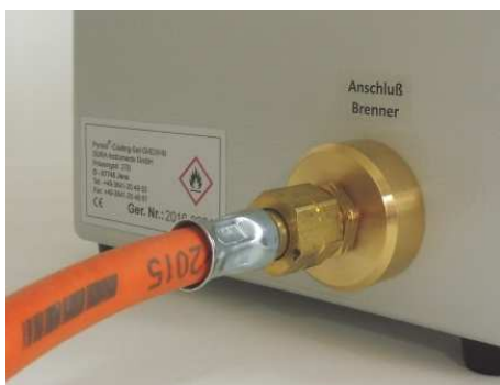
Figura 3: Conexión del quemador - Manguera
