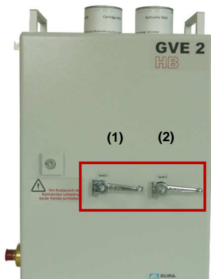
Figure 4 : Fermeture des vannes
