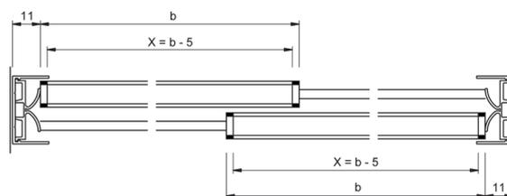
L = abertura libre · x = longitud carril guía · b = ancho de puerta / dimensión del vidrio · solapamiento: 32 mm
